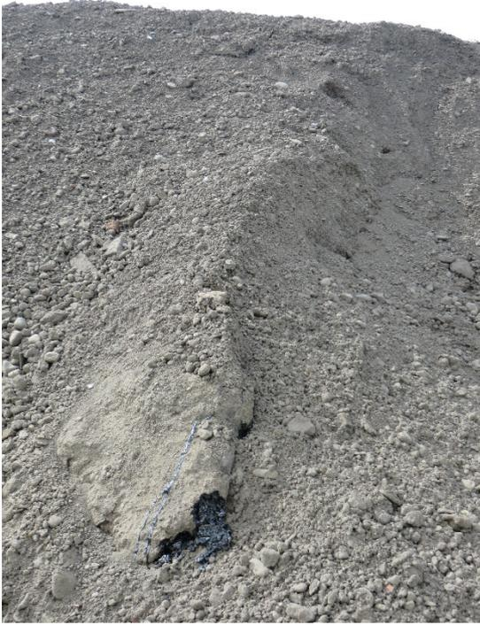
Bild 1: Bodenhaufwerk mit Teerölkonglomeraten
