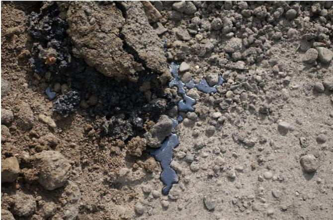
Bild 2: Von Boden umhülltes Teerölkonglomerat mit austretender Flüssigphase
