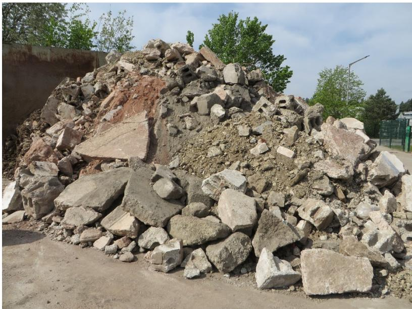
Bild 4: Boden-Bauschutt-Mischhaufwerk
